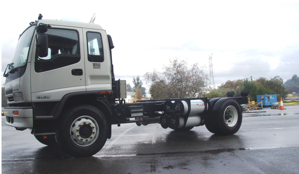
Рисунок 3.46: Новый специализированный грузовик SI CNG с запасом топлива на 200 км 17
