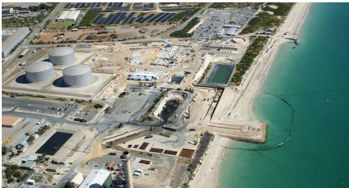
Figura 3: Foto aérea de la Planta de Desalinización de Agua Marina en Perth, Western Australia. Esta planta utiliza la osmosis inversa para desalinizar agua de mar.
