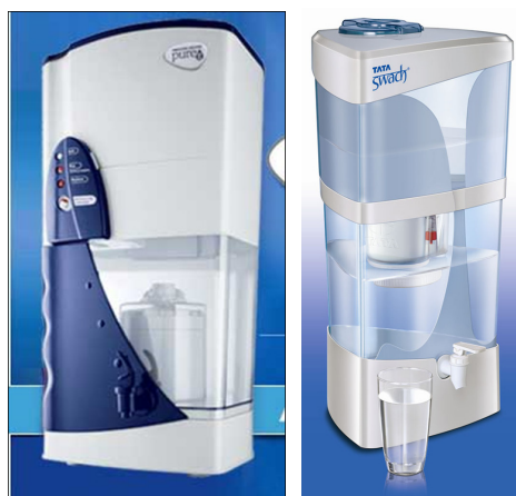
Figura 6: Productos comerciales Purait y Tata Swach. El Pureit (a la izquierda) puede tratar alrededor de 1500 litros de agua (dependiendo del modelo), usando un bloque de carbón para absorber y filtrar las impurezas, seguido de desinfección con cloro. El reemplazo de la unidad de cloro permite el tratamiento de 1.500 litros más. El Tata Swach (a la derecha) usa cascarilla de arroz y plata para tratar el agua, lo que permite el tratamiento de hasta 3.000 litros antes de que el llamado “bulbo” de tratamiento deba ser reemplazado.
